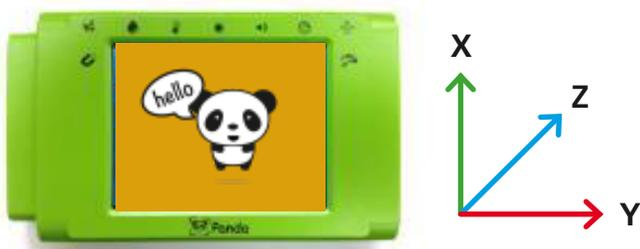
Es ist wichtig, in einer Umgebung zu arbeiten mit möglichst wenig Metall, da dieses die Werte des Sensors beeinflussen kann.
